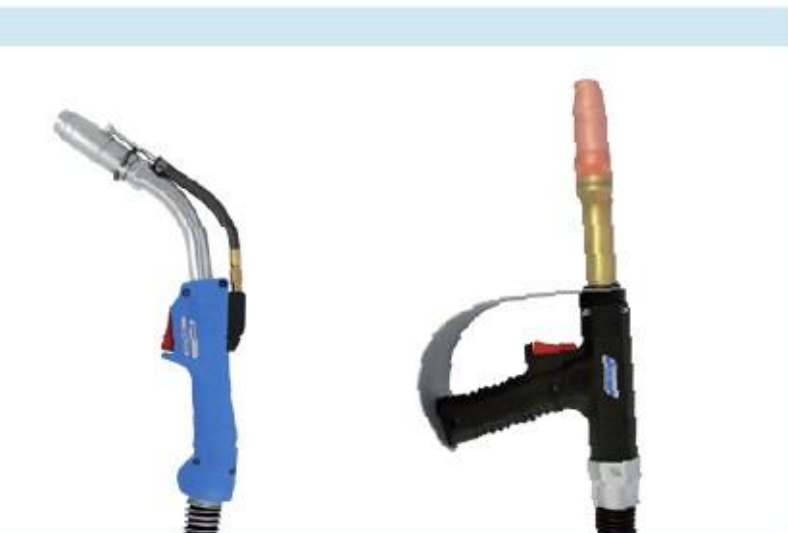
TBi9 3W C 100% (10 min.) Mix : 600 A CO 2 : 650 A Ø 1.2 - 1.6 mm 3-Kreis Kühlung 3-circuit cooling / refroidissement en 3 circuits / 3 circuitos de refrigeración
